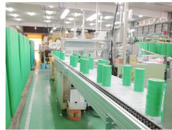
アップデートは、粘着のメカニズムにも及んでいます。どんな素材にもくっつき、なおかつ剥がしやすいという相反する要素を1本のテープに集約させた粘着テープ。その世界は奥深く、粘着剤や剥離剤の組成・配合をはじめ、被着体との接着具合、耐候性・耐水性・耐熱性なども考慮して粘着のメカニズムを研究開発。さらには表面の素材までも独自性を追求しているというから驚きです。表面の基材は紙、布、ビニール等がありますが、カモ井加工紙で作っている粘着テープの約8割は和紙。その生産量は国内トップクラスを誇っています。繊維の方向や絡み具合までも設計し、見切り性の良さ、薄さ、丈夫さを追求しています。脱プラ素材である和紙は環境にも配慮した製品。カモ井加工紙ではFSC認証(持続可能な森林活用・保全を目的とした制度)を受けた和紙を使い、持続可能な製品づくりにも努めています。
